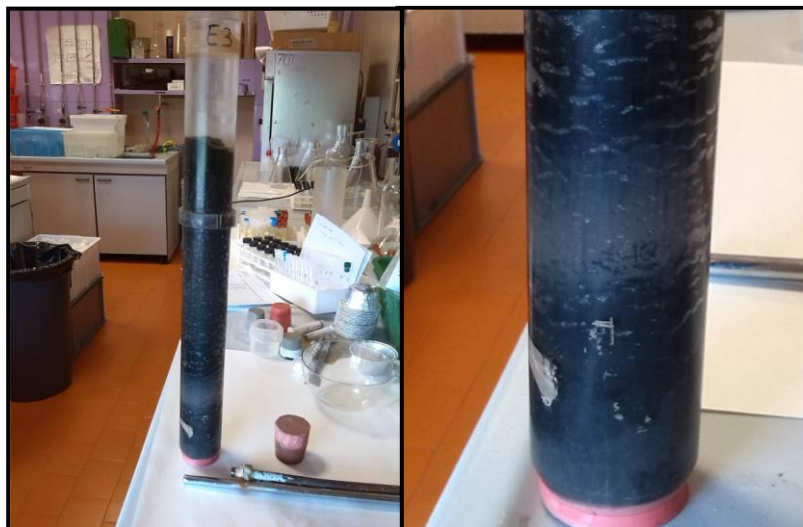
Figura 37 – A sinistra è raffigurata una delle carote di sedimento prelevate, a destra un dettaglio della stessa carota in cui si nota la zona più chiara del sedimento profondo.
