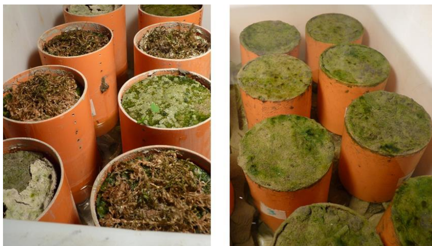
Figura 42 – Particolare dei sedimenti completamente esposti e di quelli mantenuti sommersi. Si nota il residuo di detrito vegetale rimasto sulla superficie del sedimento esposto.
